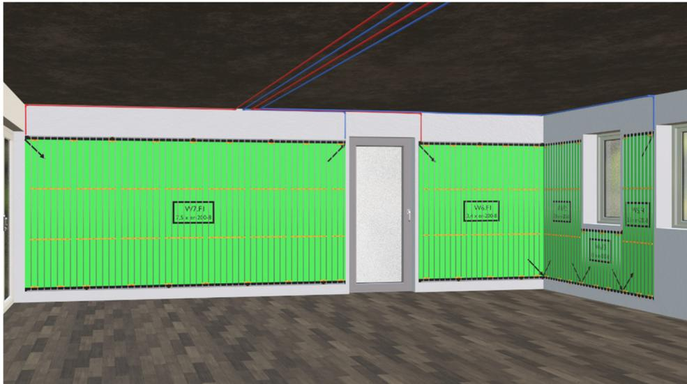
Wie beim Befestigen der Register, wird das 16er Rohr ca. alle 50 cm befestigt, wir empfehlen dir dazu herkömmliche Rohrschellen zu verwenden. Je nach gewünschten Abständen an die Wand, kann dies reduziert oder erhöht werden.
