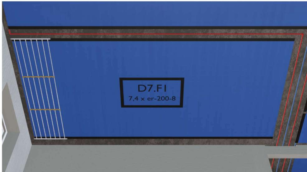
Die gelben Halteschienen der Register haben Befestigungslöcher, mit diesen können sie angeschraubt, genagelt oder anderweitig befestigt werden. Wir empfehlen jede Halteschiene an dem ersten, letzten und eines der mittleren Löcher an der Decke zu befestigen. Je nach gewünschten anliegen an die Decke, kann dies reduziert oder erhöht werden.
